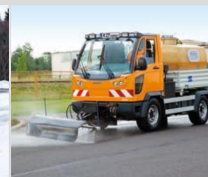
Die flexible Lösung für die perfekte Außenreinigung: mit Schwemmbalken auch für die Nassreinigung großer Flächen.
