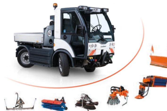
Spielend leicht: Gerätefunktionen und der hydrostatische Fahrtrieb können einfach und zentral per Joystick gesteuert werden.
