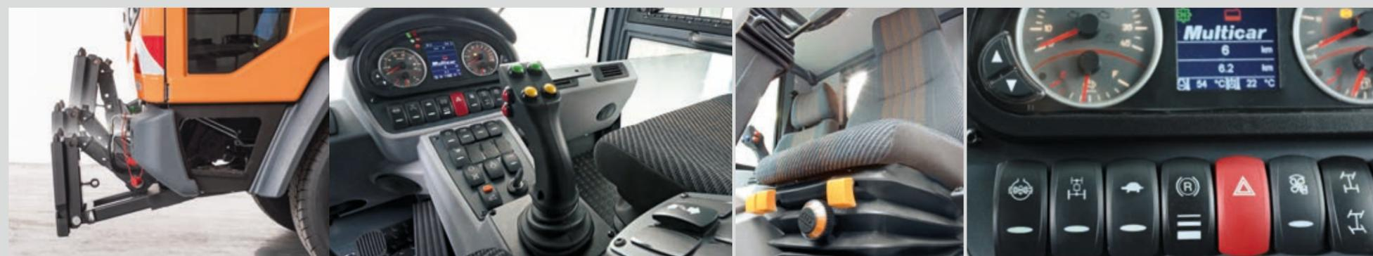
Die Basis für Multifunktionalität: das Schnellwechselsystem – zum Beispiel als Frontlift mit Geräteplatte nach DIN EN 15432-2 für Hub- und Senkfunktion zur einfachen Aufnahme von Vorbaugeräten.
