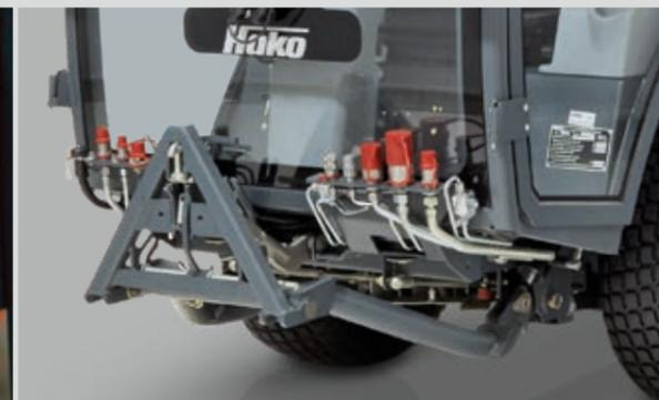
Schnell, einfach, werkzeuglos: Dank Schnellwechselsystem ist der Citymaster im Handumdrehen für den nächsten Einsatz gerüstet.
