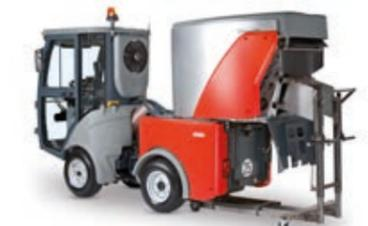
Einfach im Wechsel – Behälter- und Zubehörwechsel komfortabel und rückschonend mit Schnellkupplungssystem und Rollwagen.
